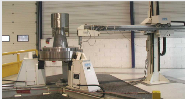
Inspection de disques de turbine de moteur d'hélicoptère
