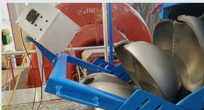
Inspection de roues PELTON
