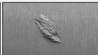
Suppression de la composante colorimétrique et de rugosité d'une image ne laissant apparaître que le défaut sans artefact
